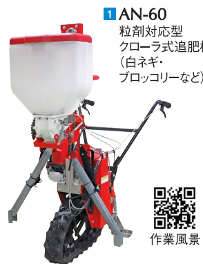
■粒状肥料 推奨粒径:2~4mm程度 散布量:9~73kg/10a ■粒剤の農薬 推奨粒径:0.3~1.7mm程度 散布量:2~10kg/10a ※畝間隔130cm、走行速度1.0m/s、両側散布時 散布幅は 30~130cm ハンドル操作で 散布高さを調節 AN-60 散布イメージ
